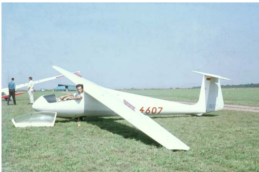
Akaflieg Darmstadt D-34d fra 1961, et spændende lille svævefly med en spændvidde på 12,65 meter, NACA 64 3 -618 vingeprofil, sideforhold 17,5 og et bedste glidetotal målt til 31,5. Flyet er bygget i glasfiber med vinger i en sandwich konstruktion med papir-honeycomb anvendt som fyldstof.
