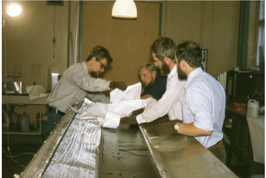
Ovenpå „risten“ vist på foregående side er lagt en 1,5 mm Al-plade, som fæstnet med skruer udgør formbunden. På formen er monteret Al-profiler, der afgrænser formen til vingeskallernes bredde, og der er heri monteret studse for tilslutning til en vacuumpumpe, der kan give limtryk over hele skallens overflade. Til lukning af formkassen benyttedes en varmebestandig plastfolie, og folien fæstnedes lufttæt ved hjælp af selvklæbende nylontape.
