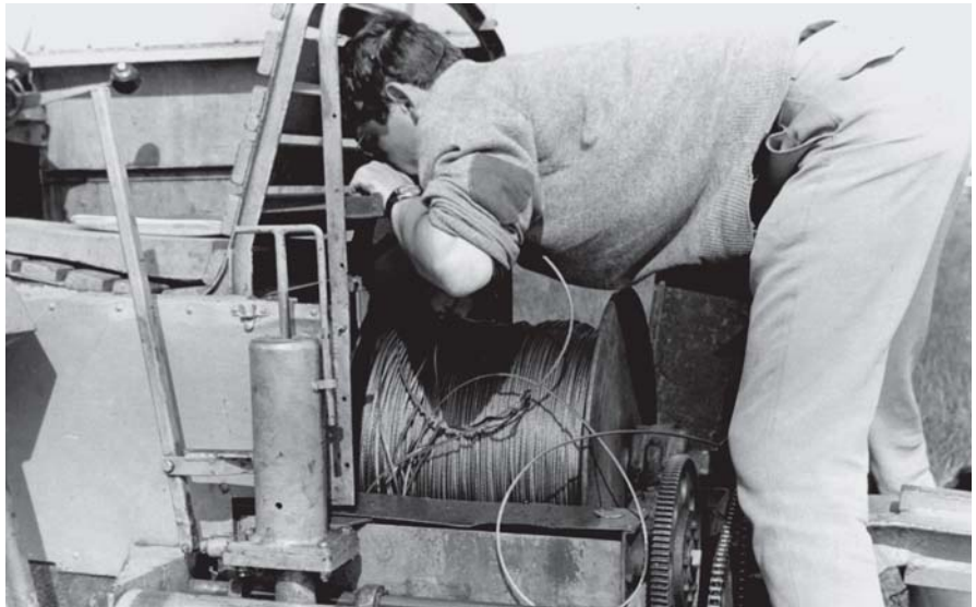
Spilførerens mareridt: Overløb på wiretromlen. Spilfører: Ole Schmidt.
