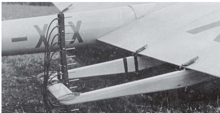
Pitotrørstravers anbragt på styrbords vinge på PFG's svævefly OY-XIX.
