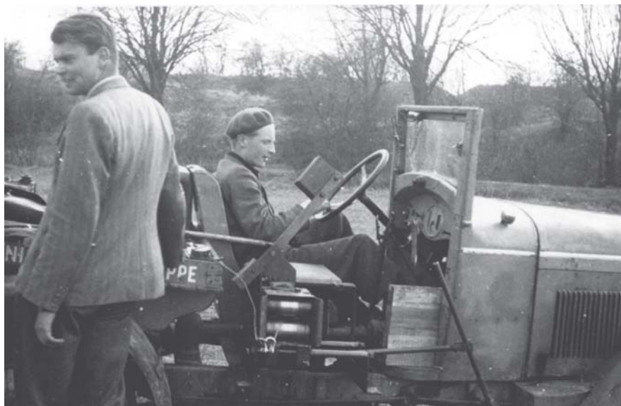
Nash'ens spil med wiresaks og manuel spoleanordning (Georg Mohr, S. Aa. Mygind).
