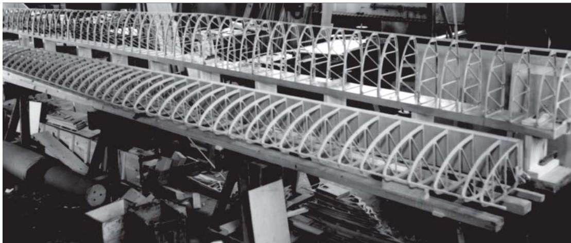
Hovedbjælke/vingeforkant inden belædning med krydsfiner.
