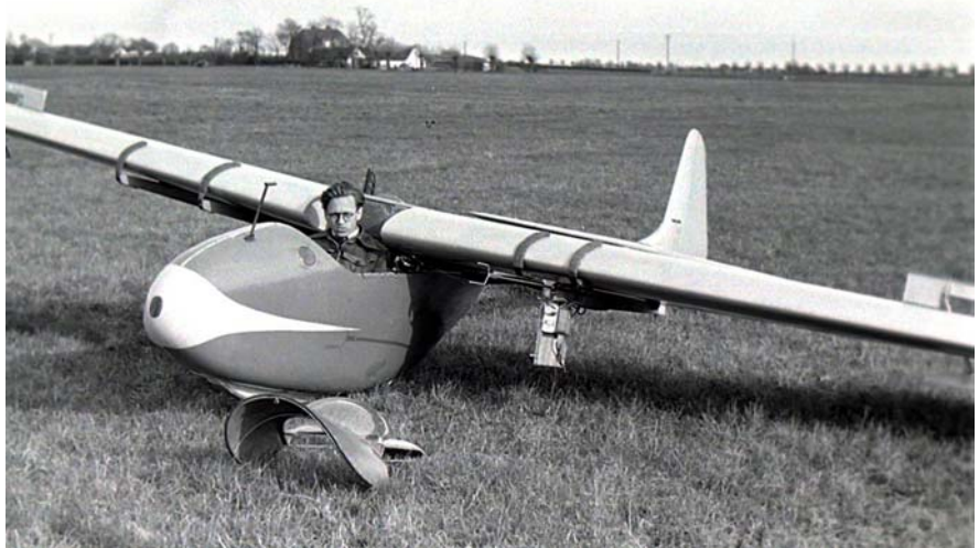
Fi'en i Avedøre med påmonteret udstyr til vingeprofil-undersøgelse i 1950. Pilot: Klarskov.
