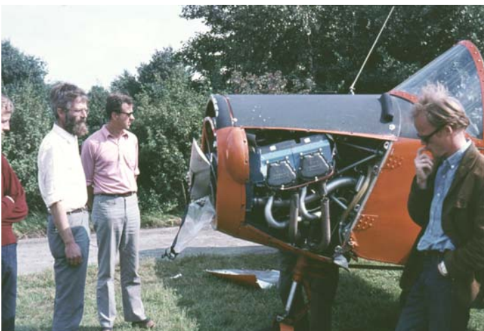
Bennike (til højre) betragter den knækkede propel og løse motor.
