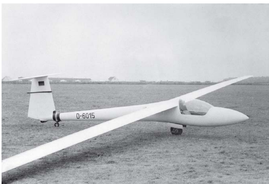
Akaflieg Braunschweigs SB8. spændvidde på 18 meter, Wortmann 62-K-153/131 vingeprofil, sideforhold 23 og et bedste glidetotal 41.
