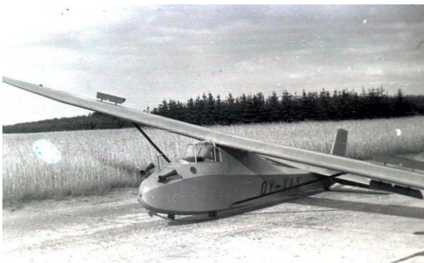
Grunau Baby OY-XAX forsynet med venturirør til luftdreven kunstig horisont.
