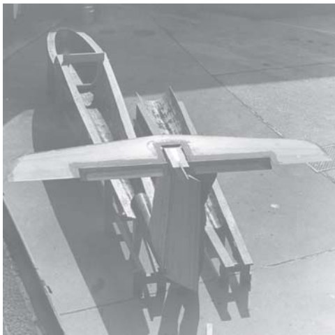
Polyt 4-kroppen med haleplan og sideror monteret. Kropskallerne sammenlimes først, når styremekanismerne er monteret.
