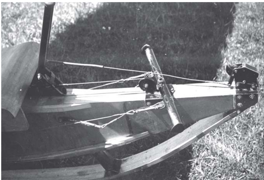
Polyt'ens spartanske manøvreudstyr: pind, hammel og wireudløser
