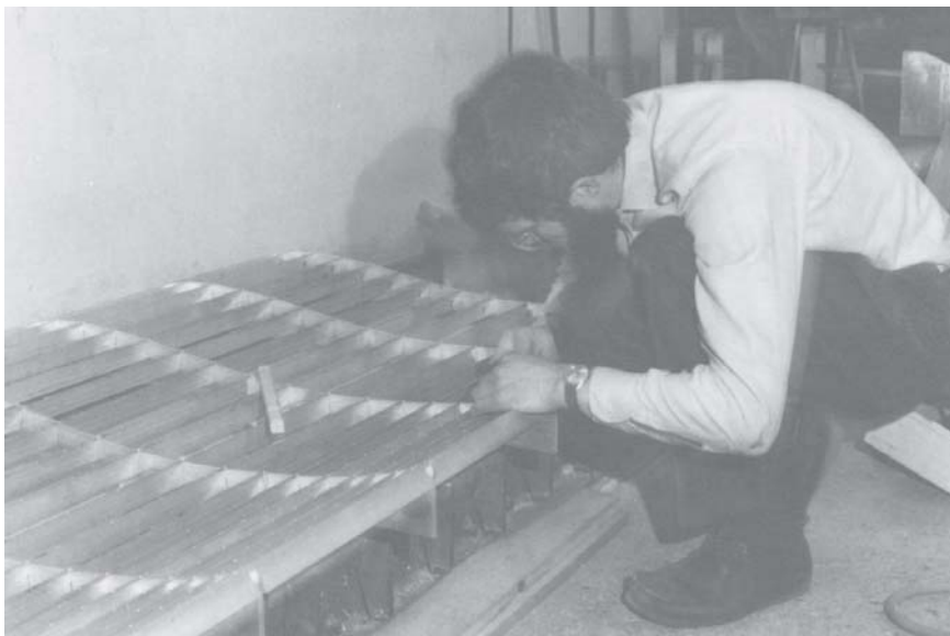
Tejlgaard arbejder på „risten“, som nr. 2 vingeformen, Prøvevingeformen er bygget op over.
