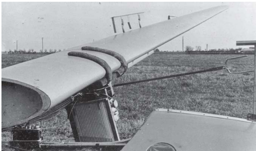
Multimanometer, pitotrørs-bom og kamera betjent af piloten monteret på Fi-en.
